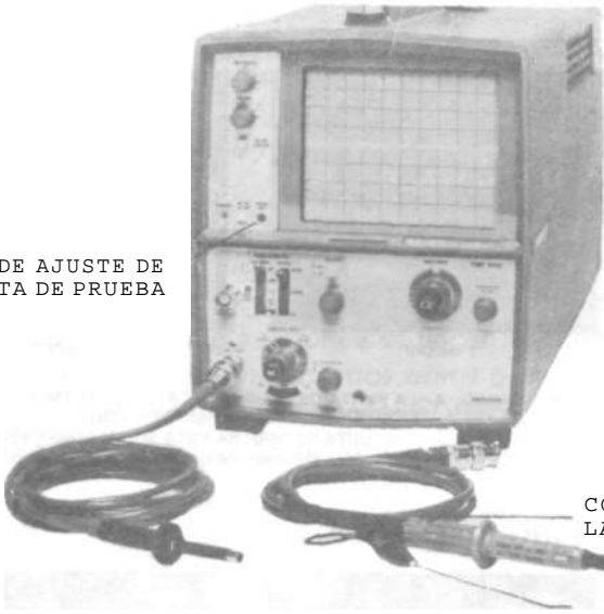
FIGURA 23. La punta de prueba X1 está conectada a la entrada Y del modelo T921. En el frente se ve una punta de prueba X10.
